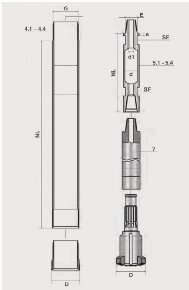
Das **Lumetrix** ermöglicht eine verrohrte Bohrung herzustellen. Die Verrohrung dient zu einem sicheren Einbau bei nicht standfesten Böden von Anker oder Pfählen.
