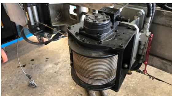
Zugwinde, befestigt an der Lafettenunterseite
